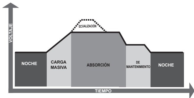
Figura 4.1. Algoritmo de carga de EcoPulse
